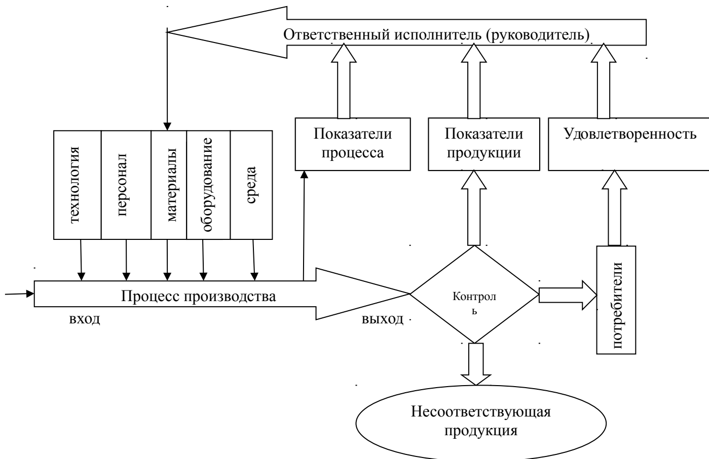
Рисунок 1 – Схема управления процессом
